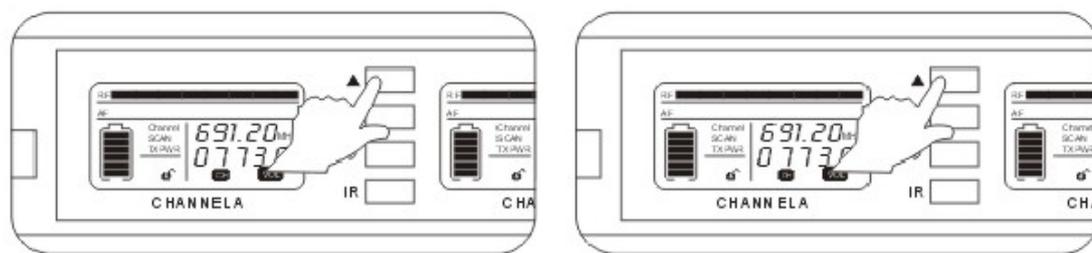
功率调节方法。按下 IR 键不放再按 1，当屏幕显示 1 或者 2 或者 3 的时候，再同时放开两个键，用 ↑ 调节功率，最后也是用红外对频实现改变手持话筒的功率。功率调节只在 A 边功能键调节，调好后，通过分别 A 边 IR 键和 B 边 IR 键来红外对频改变两支手持话筒的功率。
