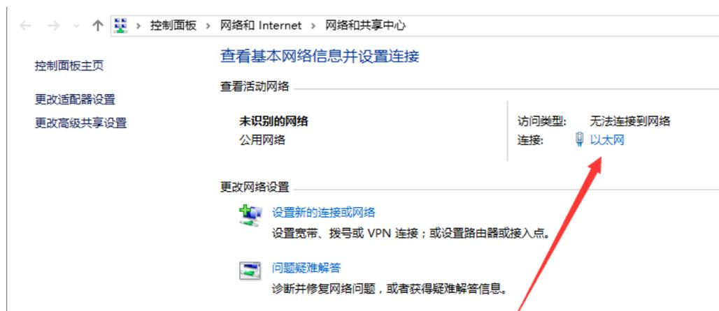
点击本地连接，打开属性，点击 TCP/IPv4 后打开属性，
